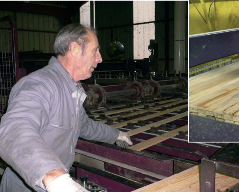
Sur la machine de découpe, l'acheminement des planches est assuré automatiquement jusqu'aux unités de sciage.
