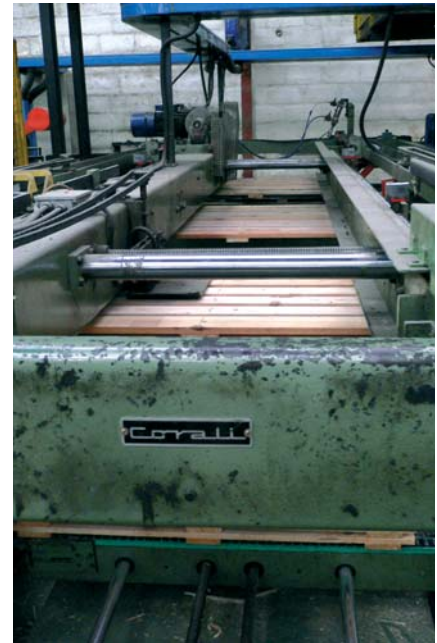
Sur la machine de découpe, l'acheminement des planches est assuré automatiquement jusqu'aux unités de sciage.
