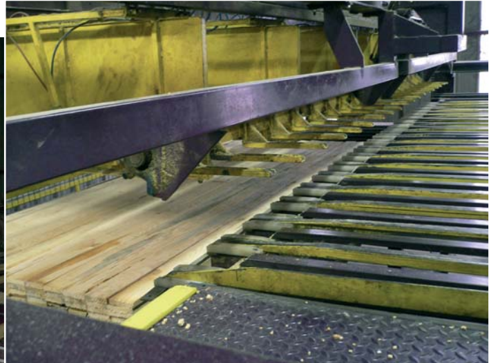
Sur la machine de découpe, l'acheminement des planches est assuré automatiquement jusqu'aux unités de sciage.
